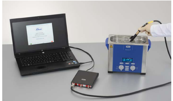
Elmasonic P 30 H während der Kavimetermessung
